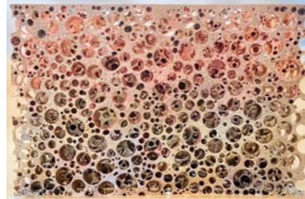
Fig. ロータス型ポーラス金属
